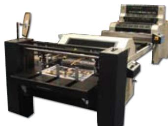
**Kompac Kwik Finish** ist ein offline Lackier- und Trocknungssystem, dass Ihnen einen schnellen und einfachen Weg zeigt um UV-, Dispersions- und Speziallacke, sowie Primer auf einer großen Vielfalt von Trägermaterialien einzusetzen: vom Zwiebelschalenpapier bis Kunststoff, ob digitale Ausgabe oder Offset.
